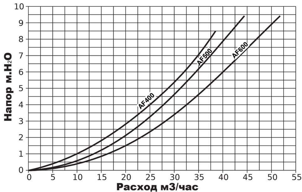
Диаграмма потери нагрузки отопительных блоков AF400, AF500, AF600 котла наружного размещения EGS серии ВКТ-F2.800, 2.900, 2.1000, 2.1100, 2.1200
