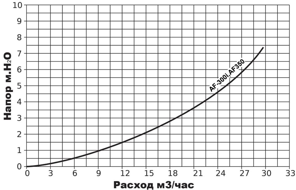
Диаграмма потери нагрузки отопительных блоков AF300i, AF350 котла наружного размещения EGS серии ВКТ-F2.600, 2.700
