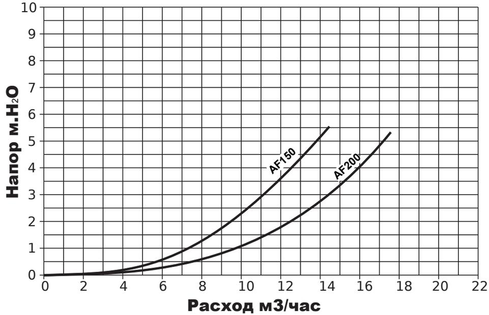
Диаграмма потери нагрузки отопительных блоков AF150, AF200 котла наружного размещения EGS серии ВКТ-F 2.300, 2.350
