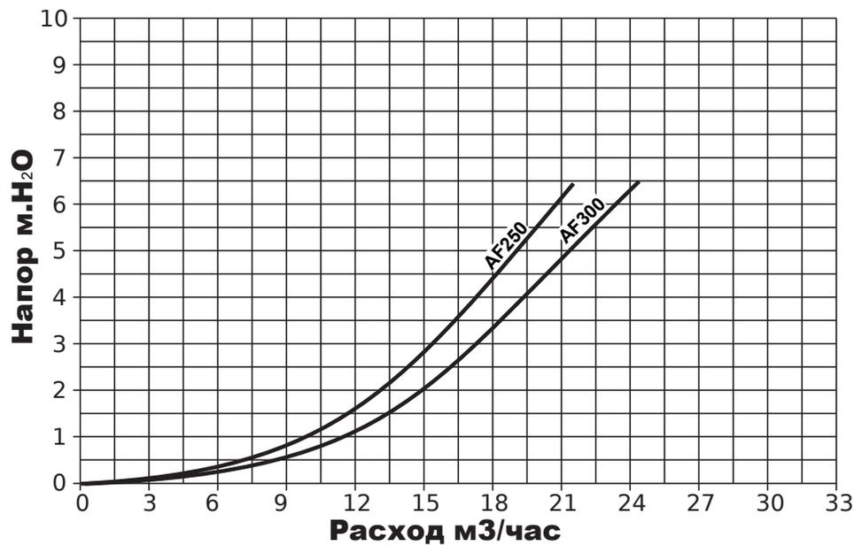
Диаграмма потери нагрузки отопительных блоков AF250, AF300, котла наружного размещения EGS серии ВКТ-F 2.500, 2.600,
